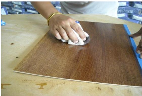
用潔淨軟布將沒有被木料吸收的護木油推散同時拋光，木料會顯現像打蠟後具有光澤度。
