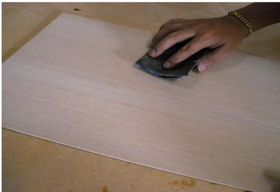
傢俱依序以砂紙研磨至 240 號，橡木研磨至 180 號。地板研磨至 180 號。
